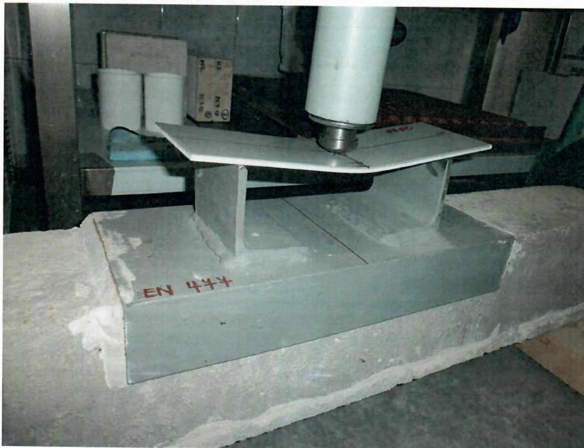
Obr.č.1 – Zkušební vzorek po zkoušce nárazem
