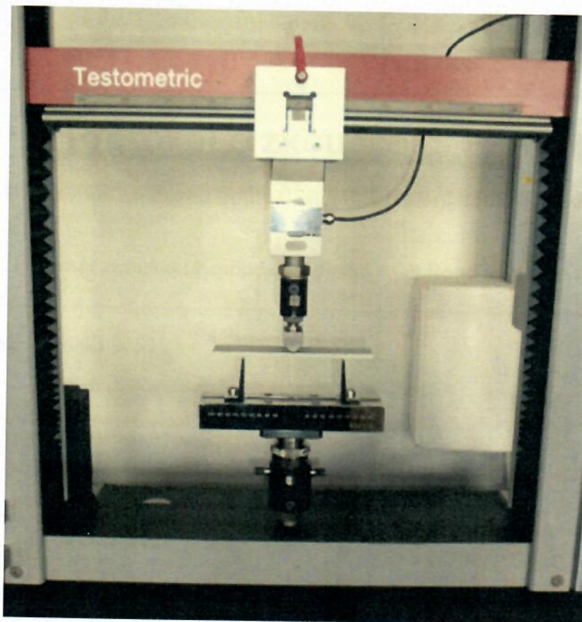
Obr.č.1 – Uspořádání zkoušky pevnosti v ohybu.
